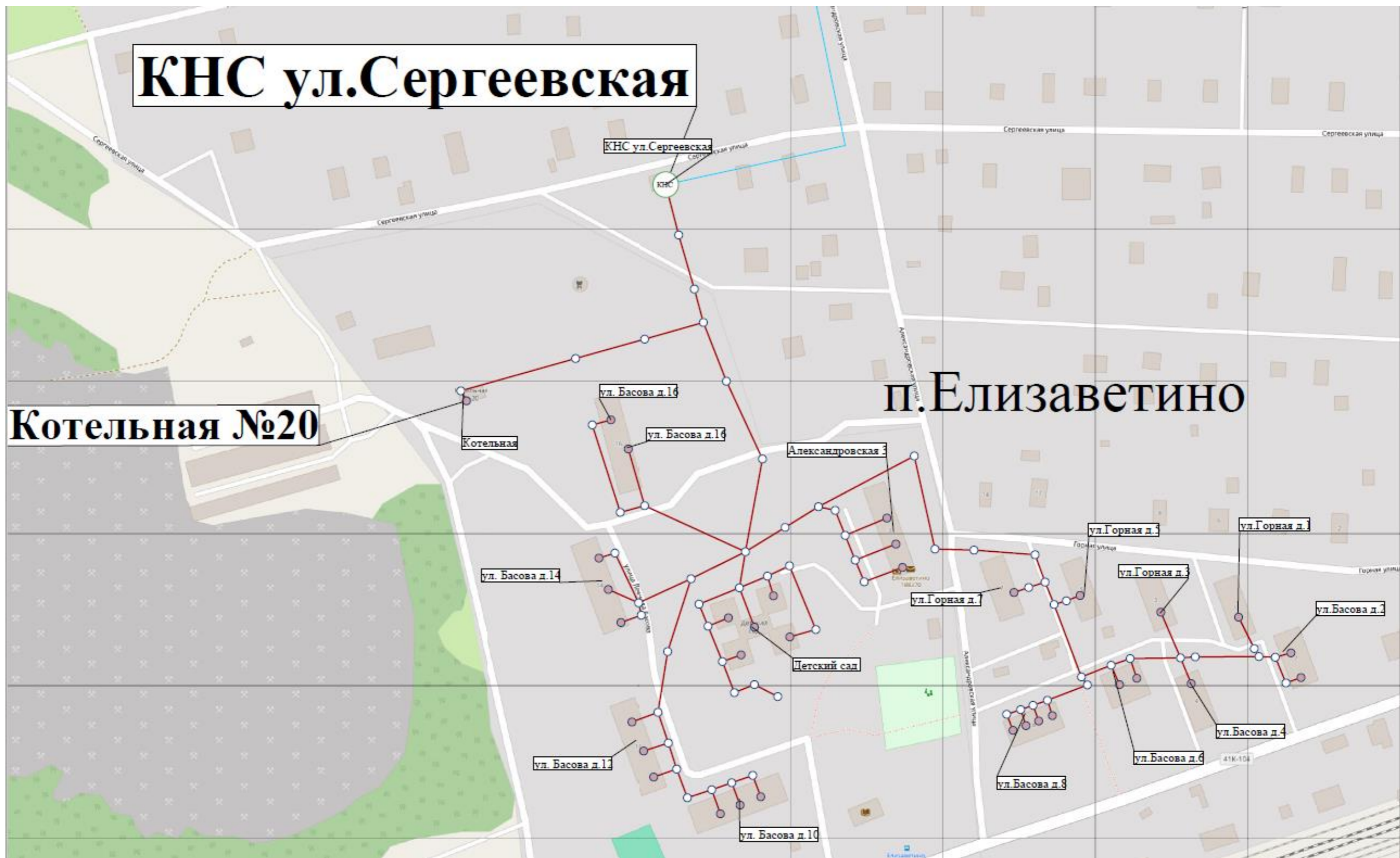
Рисунок 3. Трассировка сетей водоотведения в п. Елизаветино
