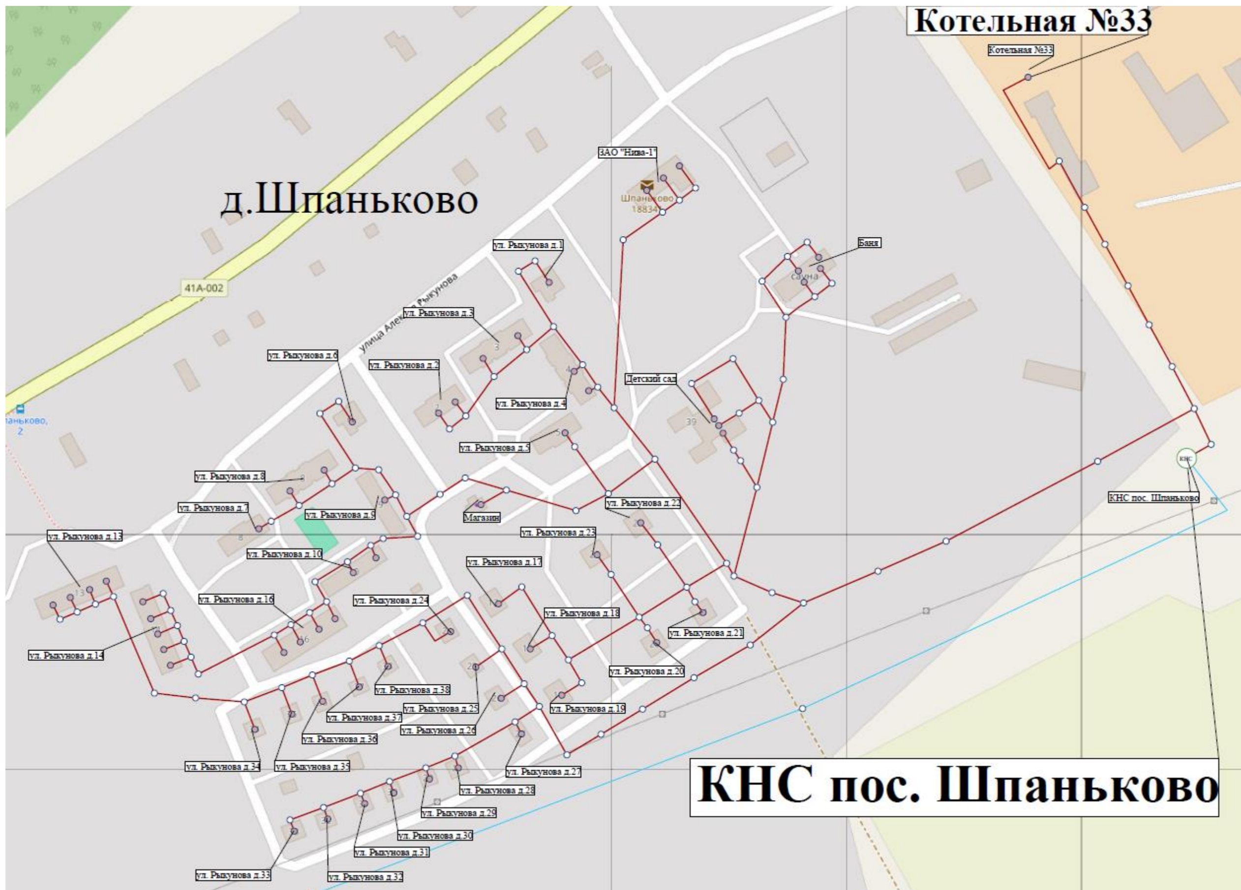
Рисунок 4. Трассировка сетей водоотведения в д. Шпаньково
