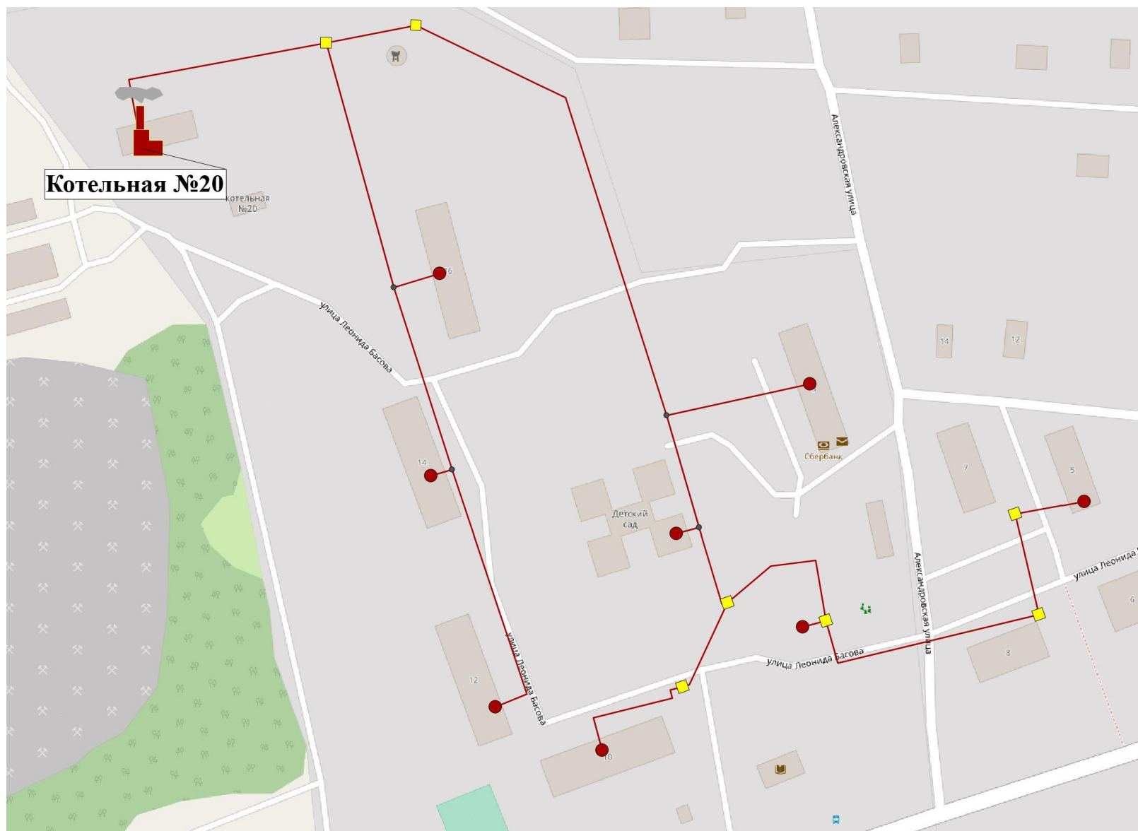
Рисунок 1.3.2. Схема тепловых сетей котельной №20 пос. Elizavetino (контур ГВС)
