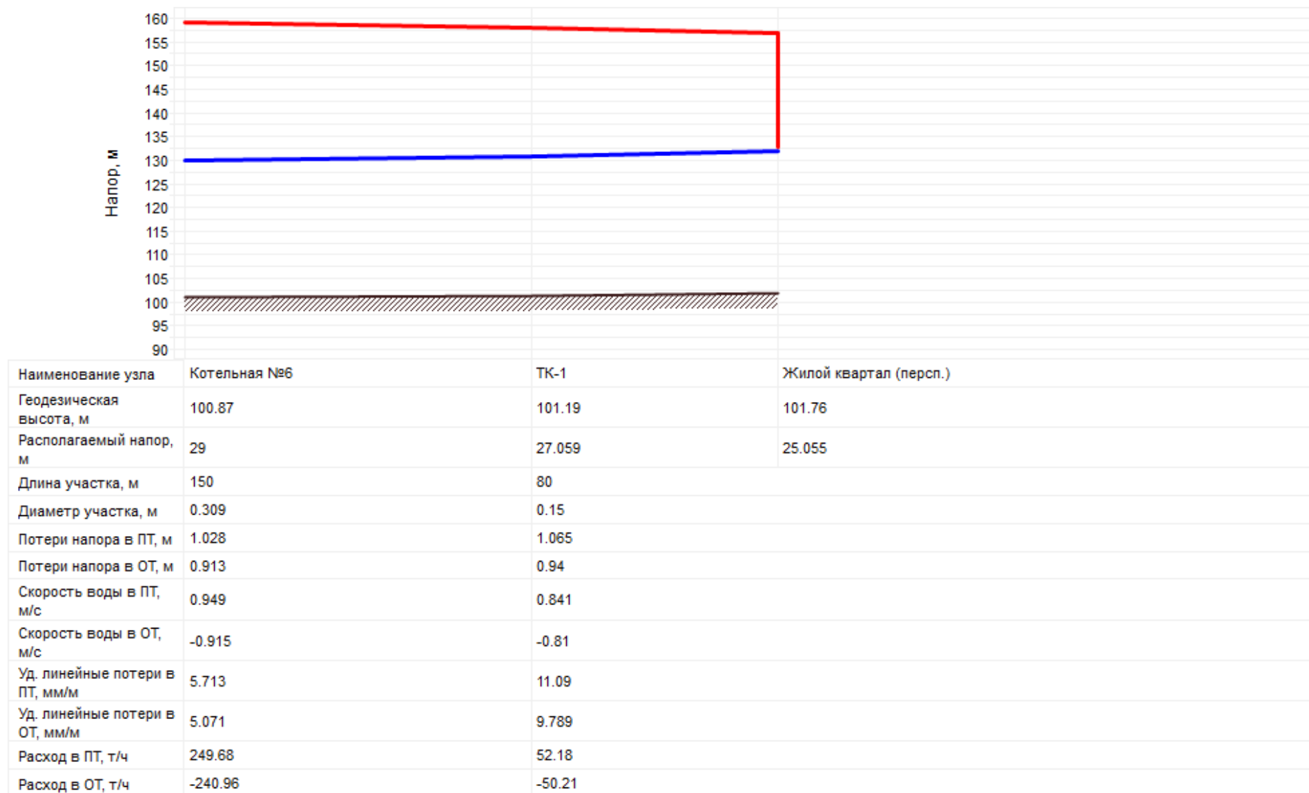
Рисунок 52. Пьезометрический график от котельной №6 с. Рождествено до перспективного «Жилого квартал»
