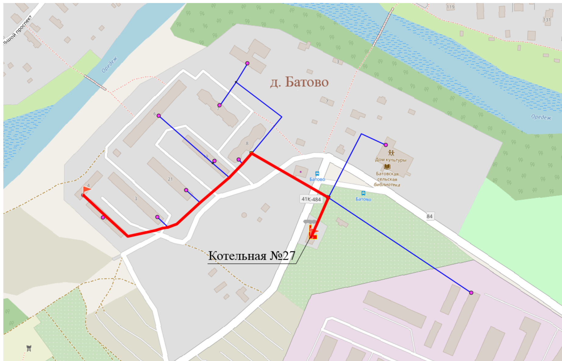
Рисунок 13. Путь построения пьезометрического графика от котельной №27 д. Батово (контур отопления) до д. 4
