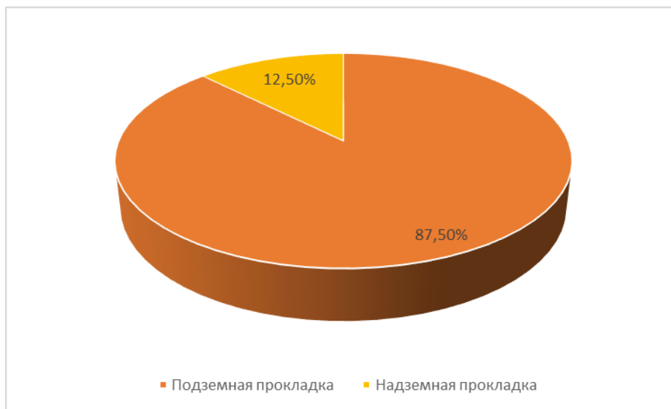
Рисунок 11 Распределение сетей отопления котельной №17 по типу прокладки
