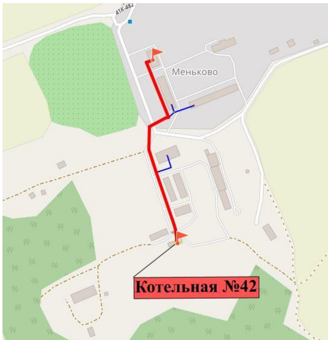
Рисунок 30 Путь пьезометрического графика Котельная №42-ул. Меньково, д. 88 (контур отопления)
