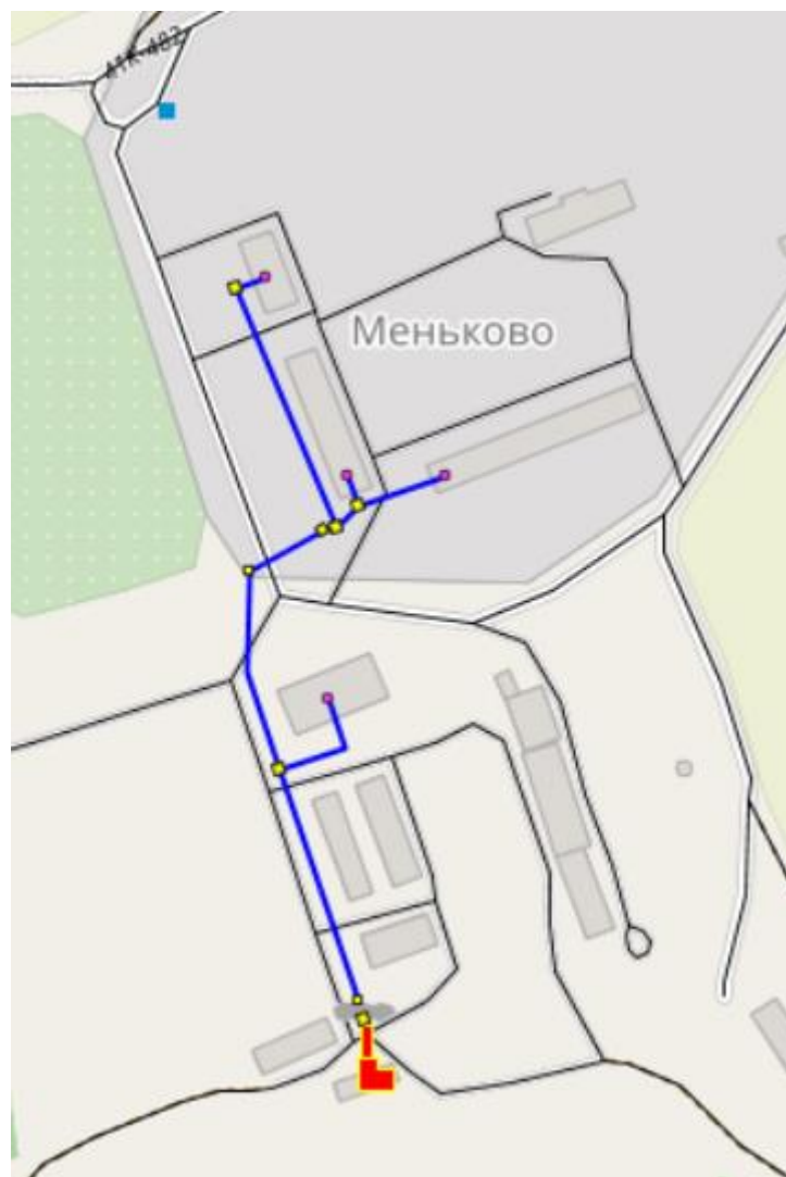
Рисунок 61 Схемы тепловых сетей котельной №18 пос. Высокоключевой на 2035 год (контур отопления и ГВС)
