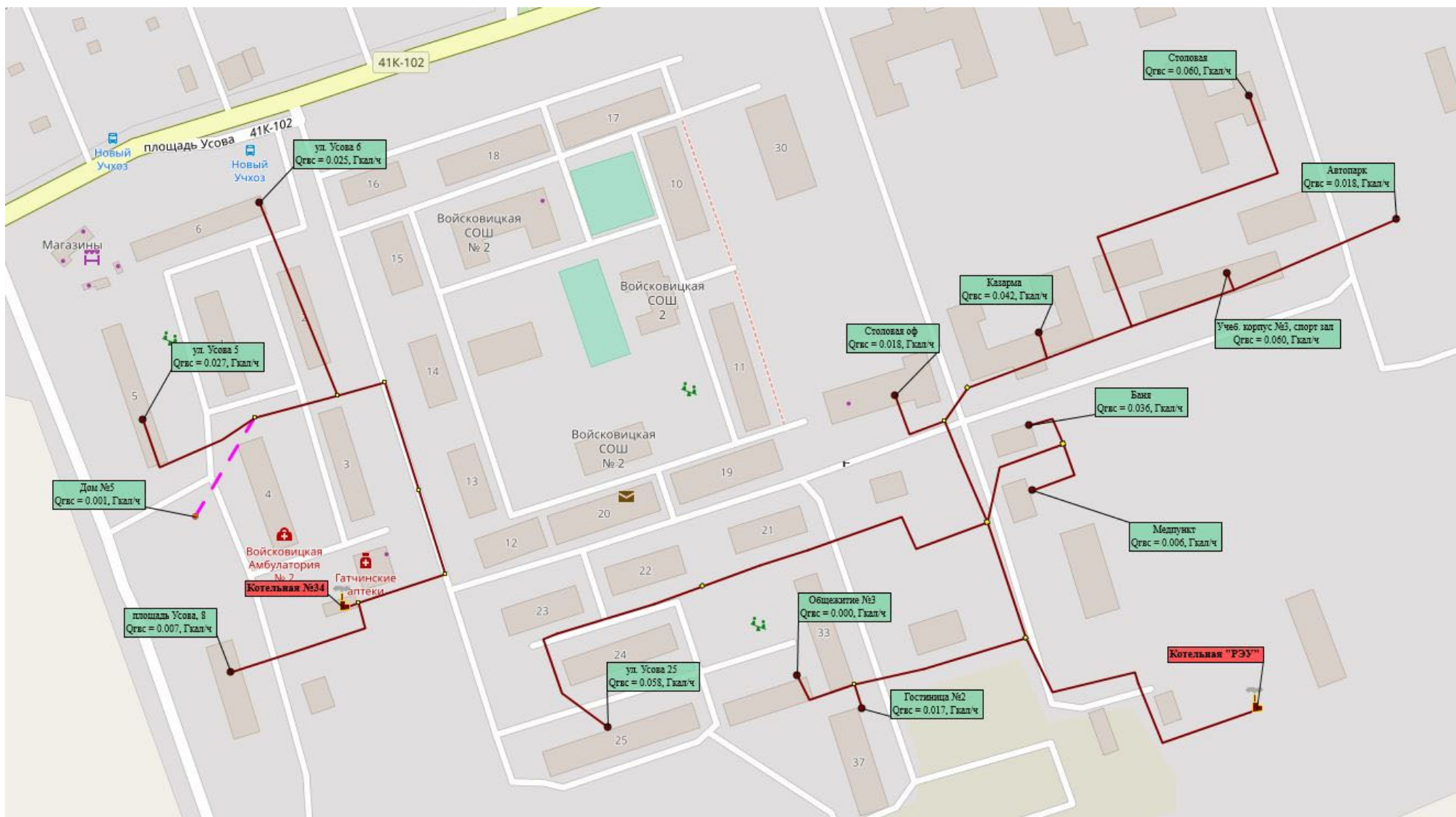
Рисунок 4.2.7 Схемы тепловых сетей котельной ФГБУ «ЦЖКУ» пос. Новый Учхоз на 2035 год (контур ГВС)
