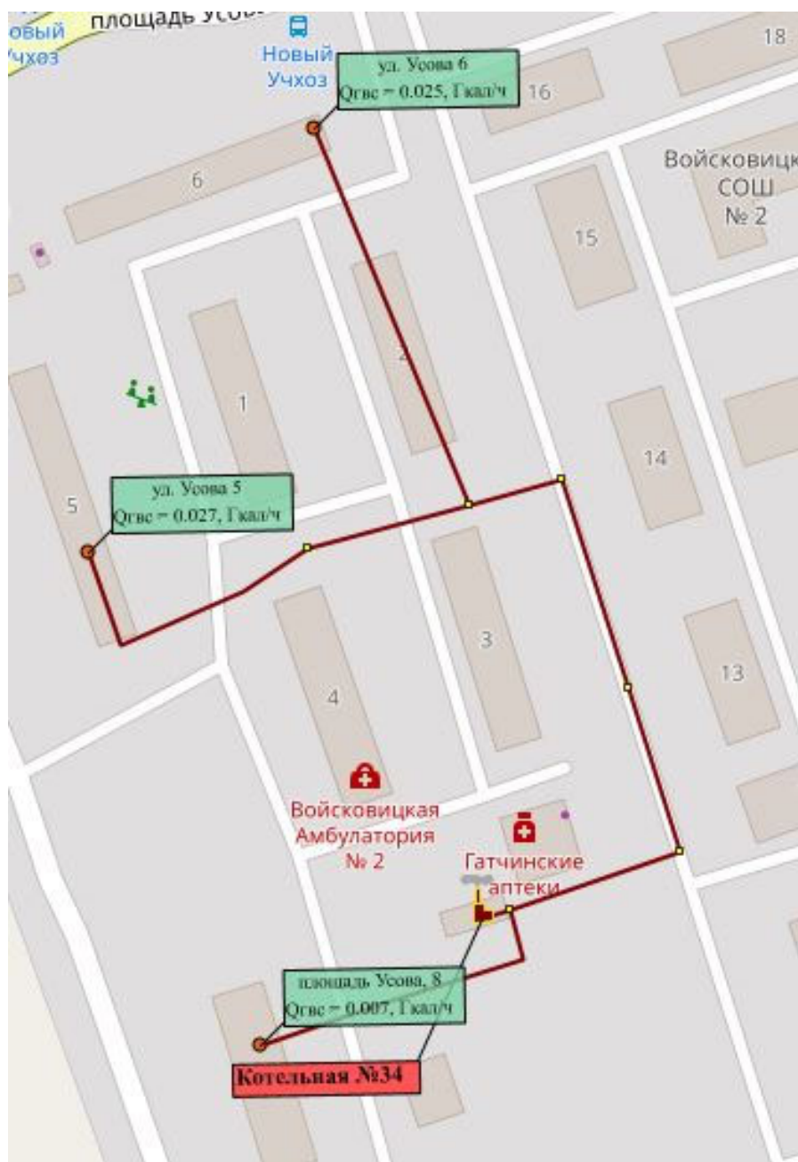
Рисунок 1.3.5 Схема тепловых сетей котельной №34 пос. Новый Учхоз (контур ГВС)
