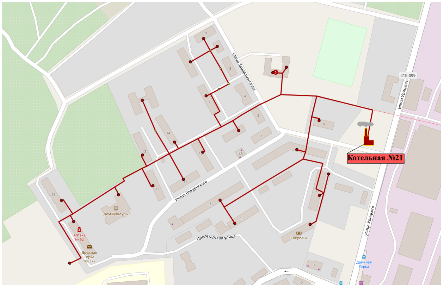
Рисунок 5. Схема тепловых сетей котельной №21 пос. Дружная Горка (контур ГВС)
