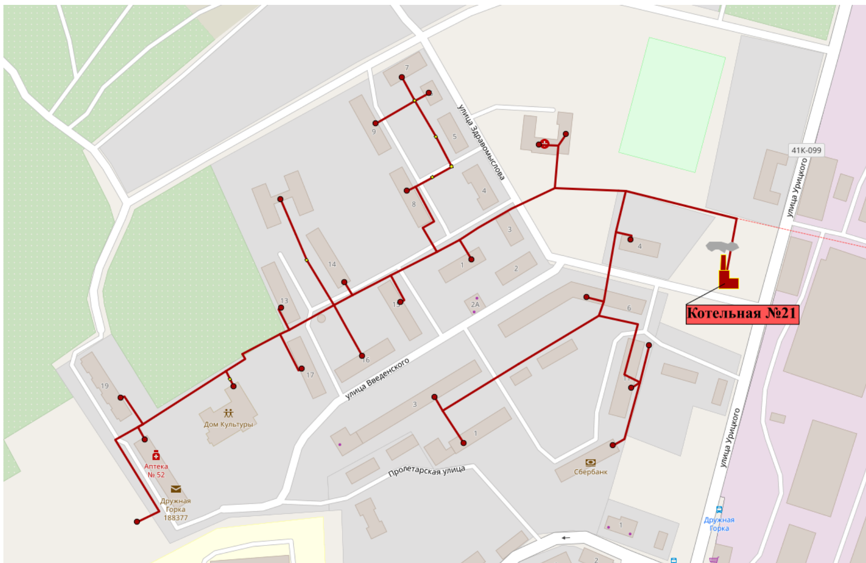
Рисунок 56. Схема тепловых сетей котельной №21 пос. Дружная Горка на 2035 год (контур ГВС)
