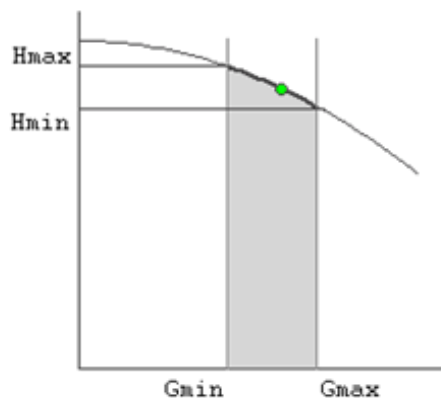
Рисунок 46. Напорно–расходная характеристика насоса
