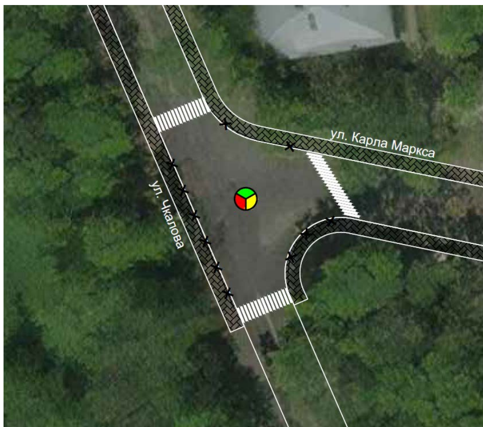
Рисунок 4.4.5.1 – Концептуальная схема ОДД на пересечении ул. Чкалова – ул. Карла Маркса
