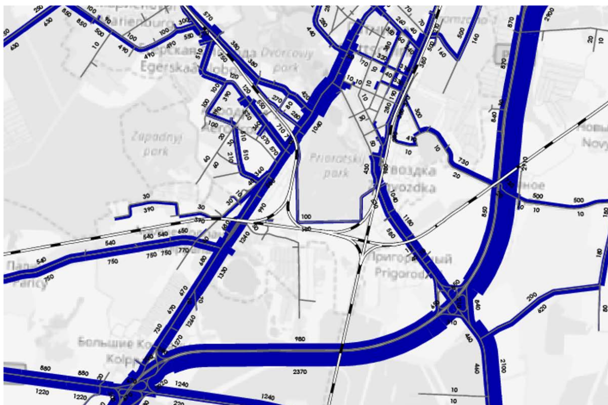
Рисунок 4.1.2.1 – Картограмма интенсивностей движения индивидуального транспорта при базовом сценарии до 2027
