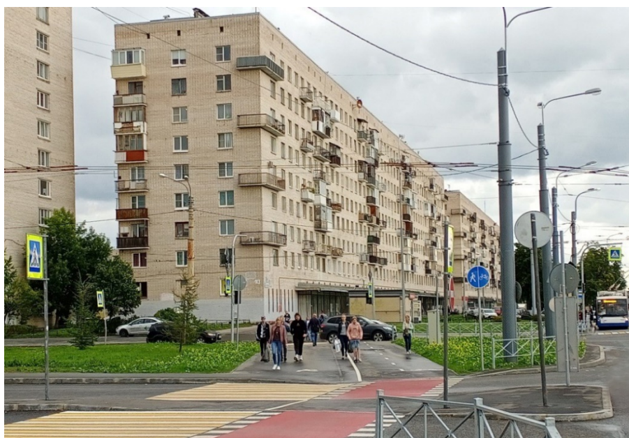
Рисунок 4.7.2.13 – Пример организации нерегулируемого пересечения велосипедной дорожки и проезжей части в Санкт-Петербурге
