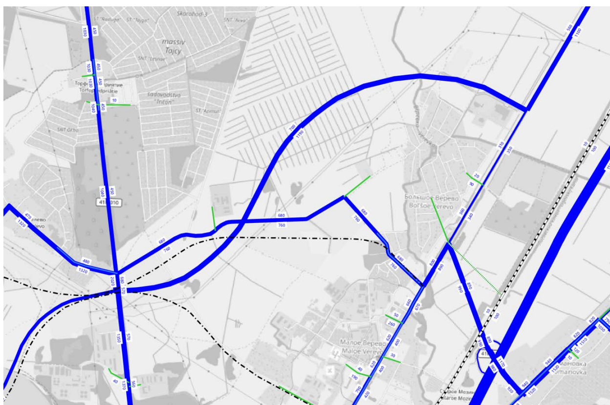
Рисунок 4.1.1.4 – Картограмма интенсивности первого варианта трассировки обхода на участке от а/д Р-23 до а/д 41К-010 в утренний час пик
