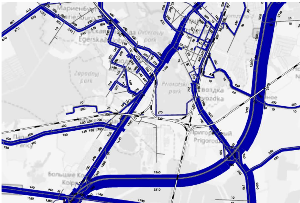
Рисунок 4.1.2.3 – Картограмма интенсивностей движения индивидуального транспорта при базовом сценарии до 2037 года
