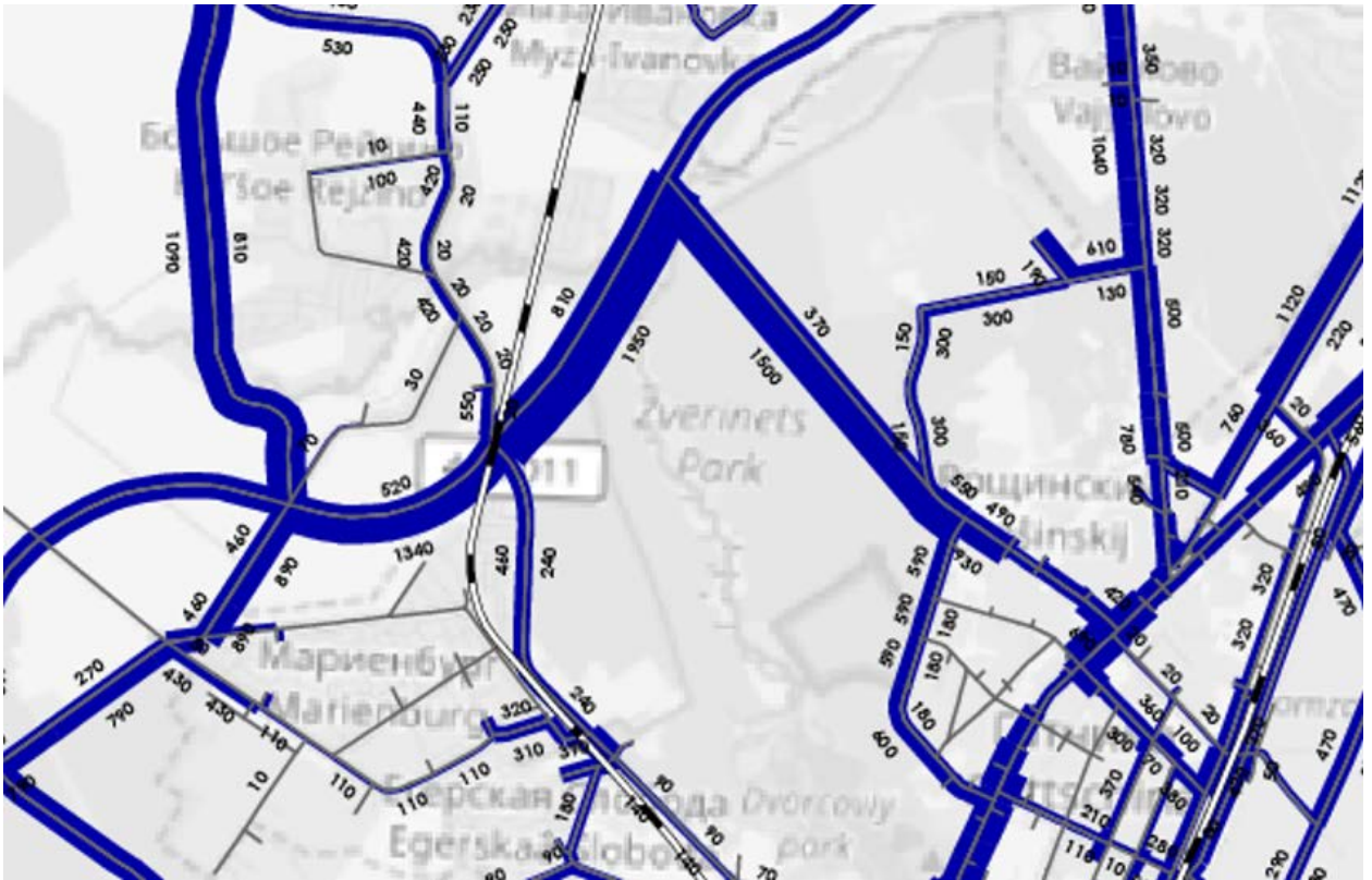
Рисунок 4.1.1.5 – Картограмма интенсивностей второго варианта трассировки и продолжения Рошинской улицы в утренний час пик
