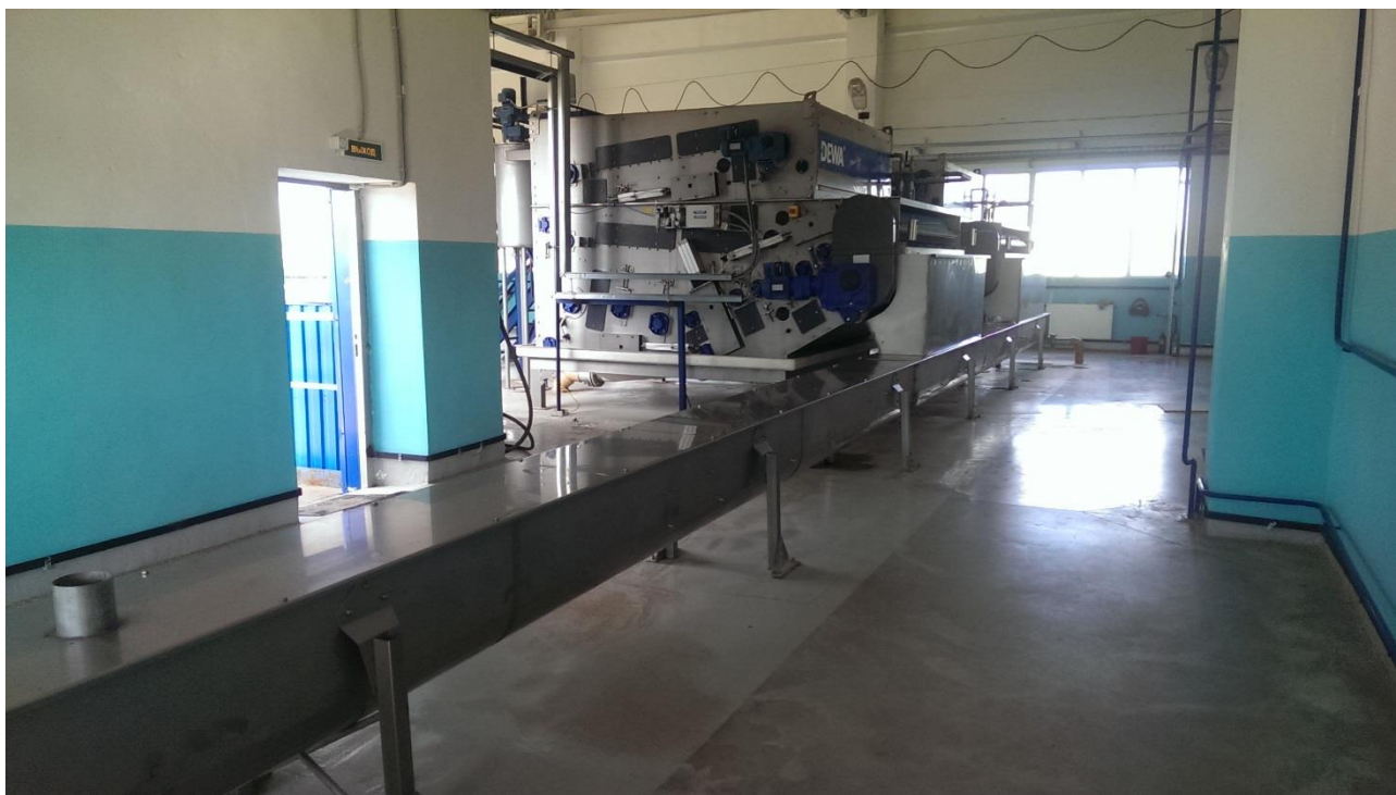
Рисунок 46 - Ленточные пресс-фильтры и шнековый транспортер
