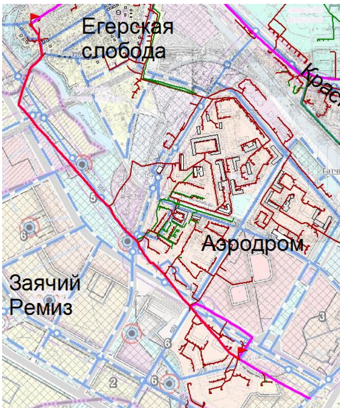
Рисунок 87 - Схема выводимого из эксплуатации самотечного канализационного коллектора от ул. Старая дорога до ул. Комсомольцев-подпольщиков (красная линия)
