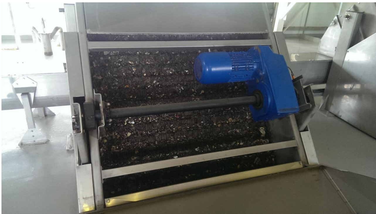
Рисунок 36 - Механизированная ступенчатая решетка с шириной прозоров 3 мм
