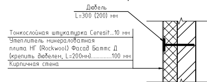
Деталь устройства фасада
