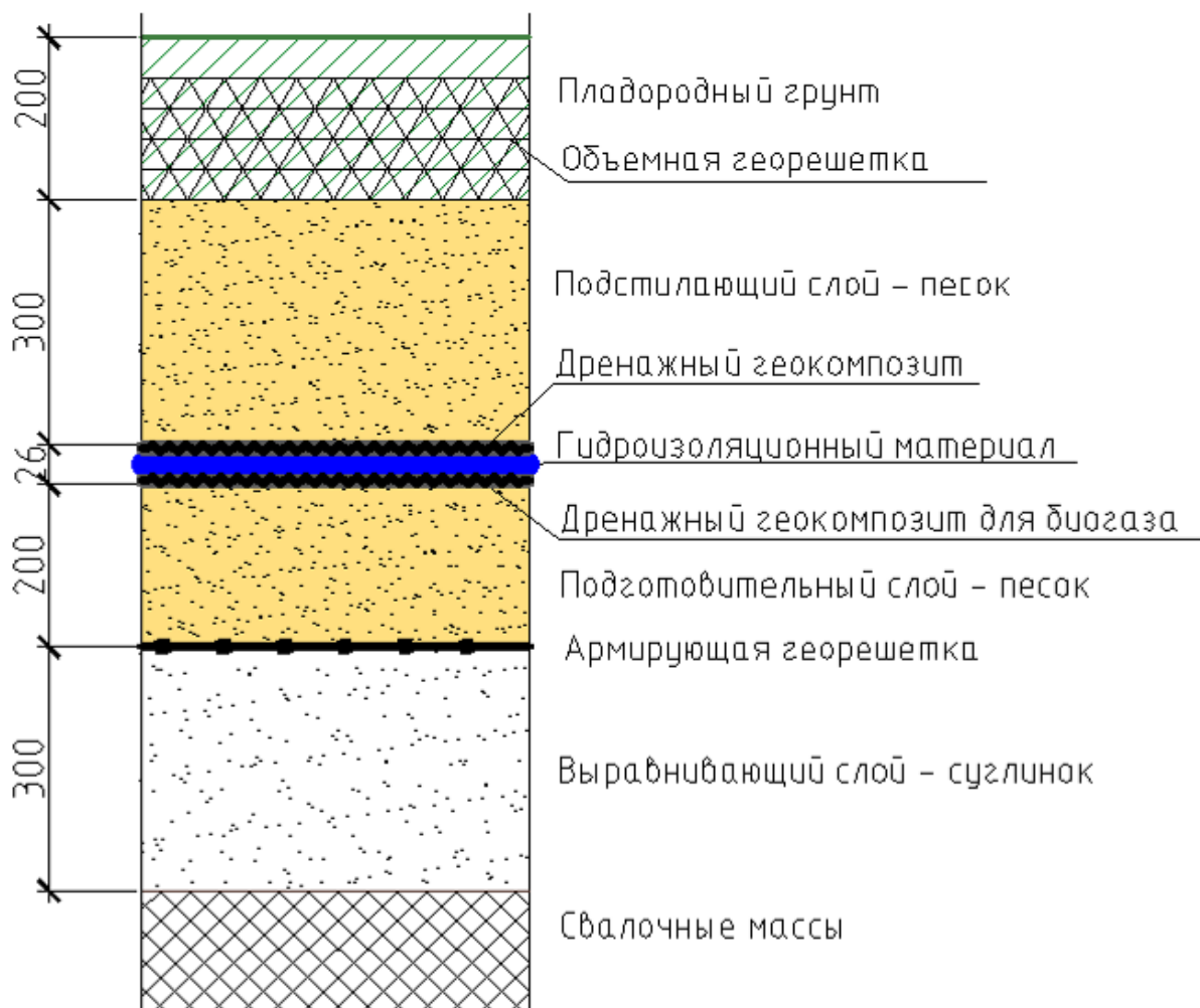
Рисунок 4.1. Защитное покрытие после проведения биологического этапа рекультивации
