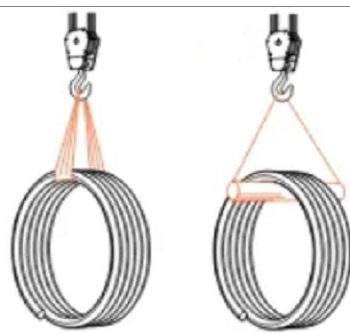
Схема строповки бухты с трубопроводом
