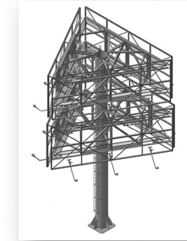
**2.14. Щит ( билборд ) пятисторонний** - щитовые рекламные конструкции среднего формата, имеющие внешние поверхности, специально предназначенные для размещения рекламы. Щиты состоят из фундамента, каркаса, опоры и информационных полей в количестве 5 штук. Площадь информационных полей щита определяется общей площадью его сторон. Обычно используются вблизи торговых центров, гипермаркетов или строительных магазинов;
